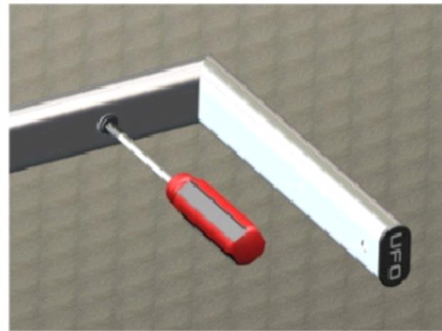
**1** Taşıyıcı kol üzerindeki delikler yardımcıla tavanı veya duvara markalama işlemini yapınız. Ø10 mm matkap ile duvarı veya tavanı delip dübelleri çakınız. Taşıyıcı kol verilen bağlantı elemanları ile şekildeki gibi tavanı veya duvara sıkıca tespit edilir.
